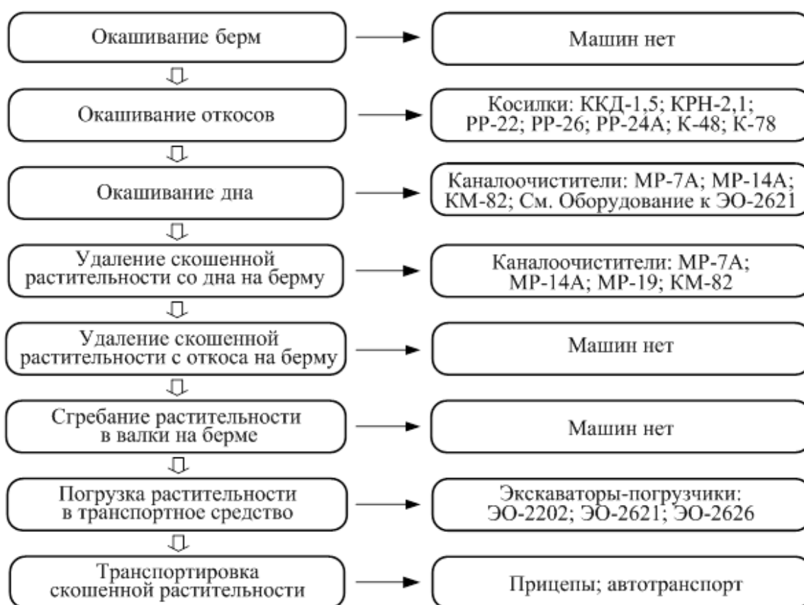
Рисунок 5 – Технология окашивания оросительных каналов и ее обеспеченность машинами в настоящее время
