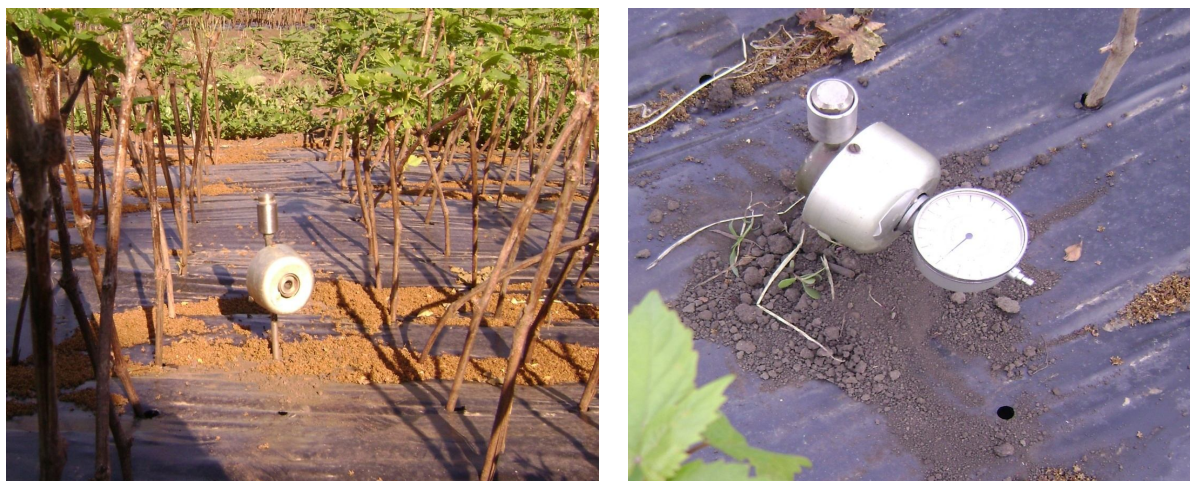
а) вид тензиометра сбоку без датчика; б) вид тензиометра сверху со съёмным датчиком
