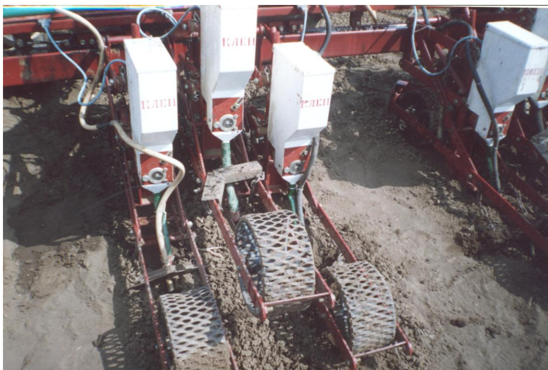
Рисунок 3 – Высевающие аппараты сеялки «Клён», оборудованные устройством для внутрипочвенного струйного полива
