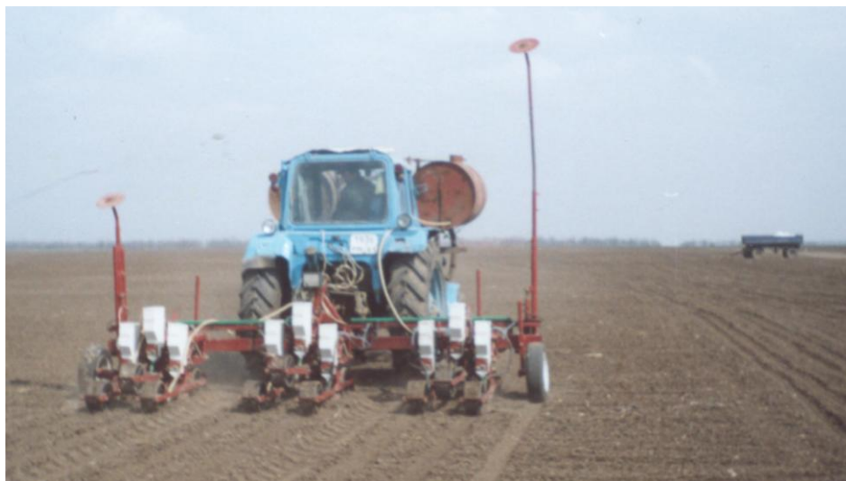
Рисунок 2 – Общий вид сеялки «Клён», оборудованной устройством для внутрипочвенного струйного полива семян одновременно с посевом
