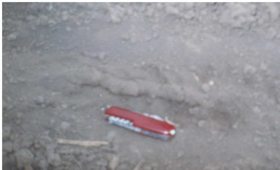
Рисунок 5 – Общий вид раскопанной увлажненной части контура увлажнения после прохода сеялки
