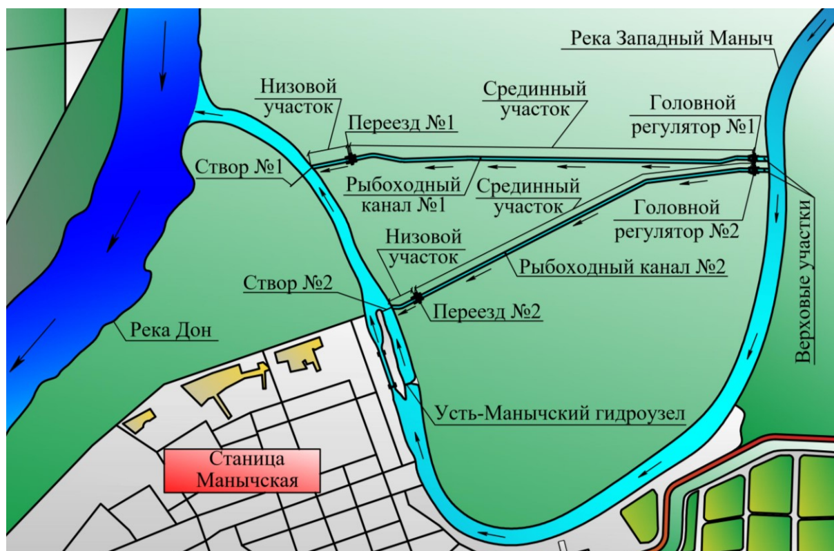
Рисунок 1 – План-схема расположения Усть-Манычских мелиоративно-рыбоходных каналов
