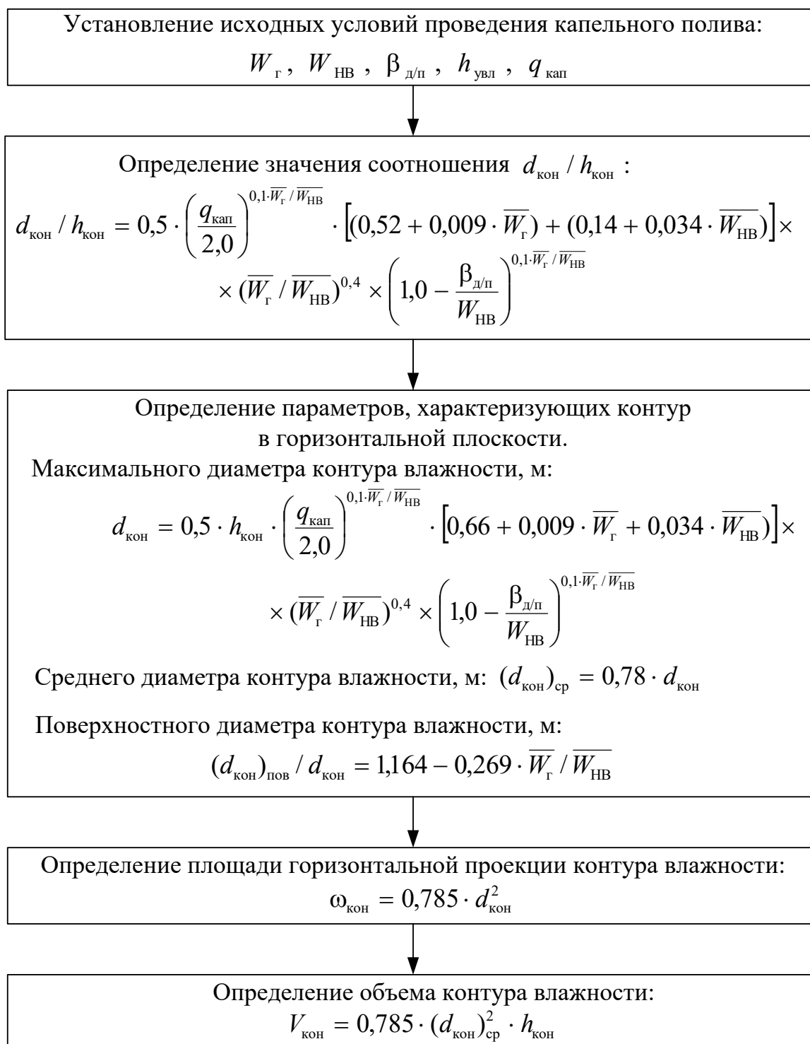
Рисунок 5 – Блок-схема методики прогнозирования геометрических размеров локальных контуров капельно-увлажняемой почвы Figure 5 – Block diagram of prediction technique of the local contours geometric dimensions of drip-moistened soil
