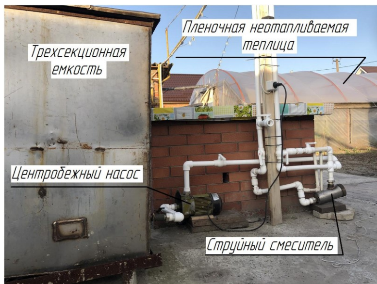
Рисунок 5 – Установка оборудования при выращивании томата с использованием защищенного грунта. Общий вид (фото В. Н. Ширяева)
