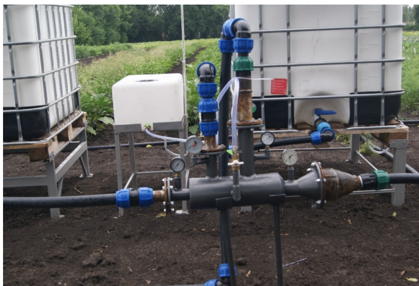
Рисунок 3 – Струйный 4-компонентный смеситель. Общий вид (фото В. А. Рудакова) Figure 3 – 4-component jet mixer. General view (photo by V. A. Rudakov)
