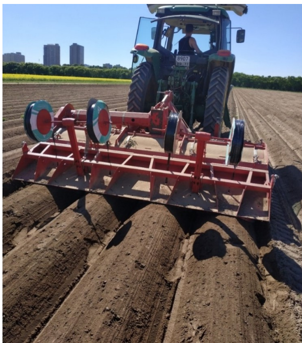
Рисунок 4 – Механизированная укладка капельной ленты специальным укладчиком на базе формирователя гребней Grimme GF-75/4 (автор фото Н. Б. Мартынова)
