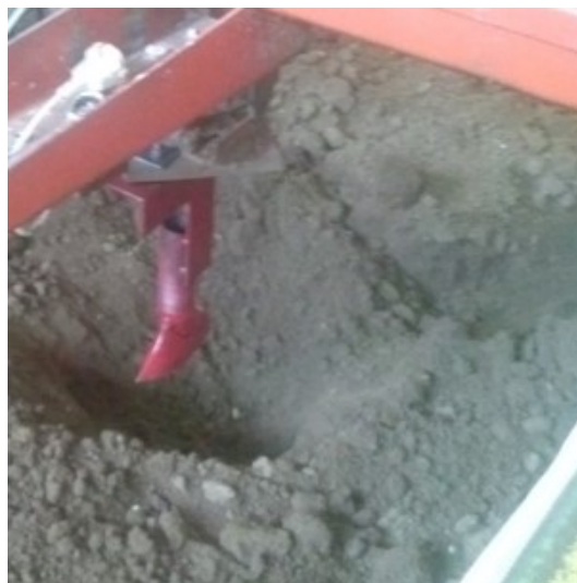
Рисунок 2 – Лабораторные исследования с моделью укладчика на грунтовом канале (автор фото Н. Б. Мартынова)
