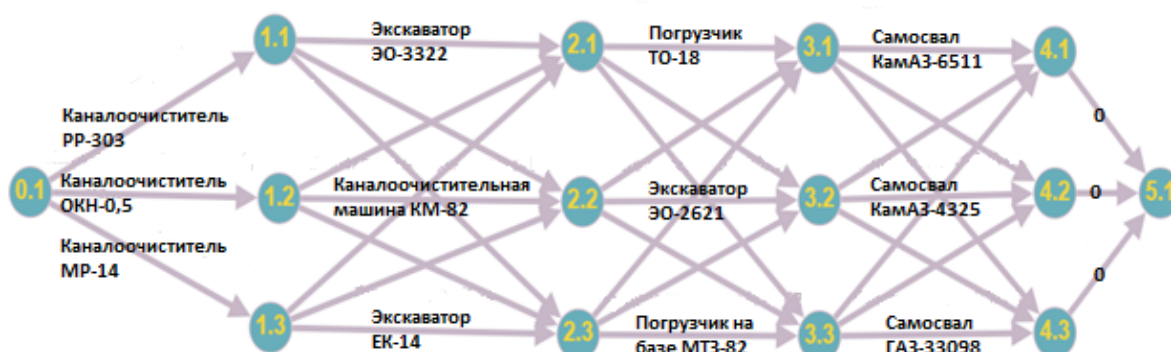
Рисунок 1 – Граф по выбору комплекса машин с наименьшими затратами на проведение очистных работ из возможных вариантов
