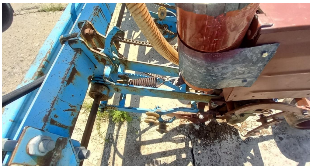
Рисунок 2 – Общий вид конструкции пружины для устойчивого хода сошника (автор фото А. М. Магомедов)
