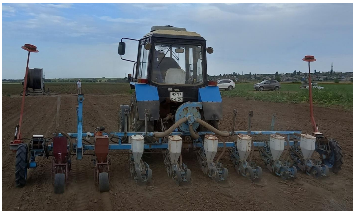
Рисунок 1 – Общий вид сеялки УПС-8 с установленными на ней двумя разработанными секциями (автор фото А. М. Магомедов)
