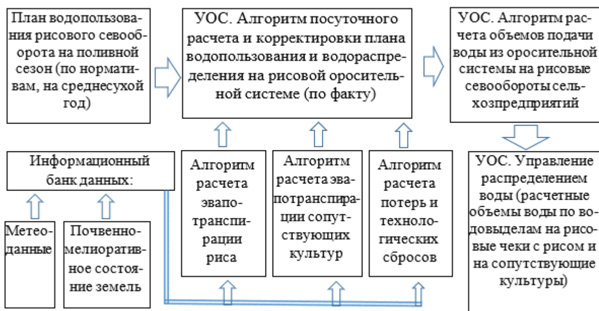
Рисунок 7 – Блок-схема расчета и корректировки планов водопользования и распределения уточненных объемов воды на рисовые севообороты
