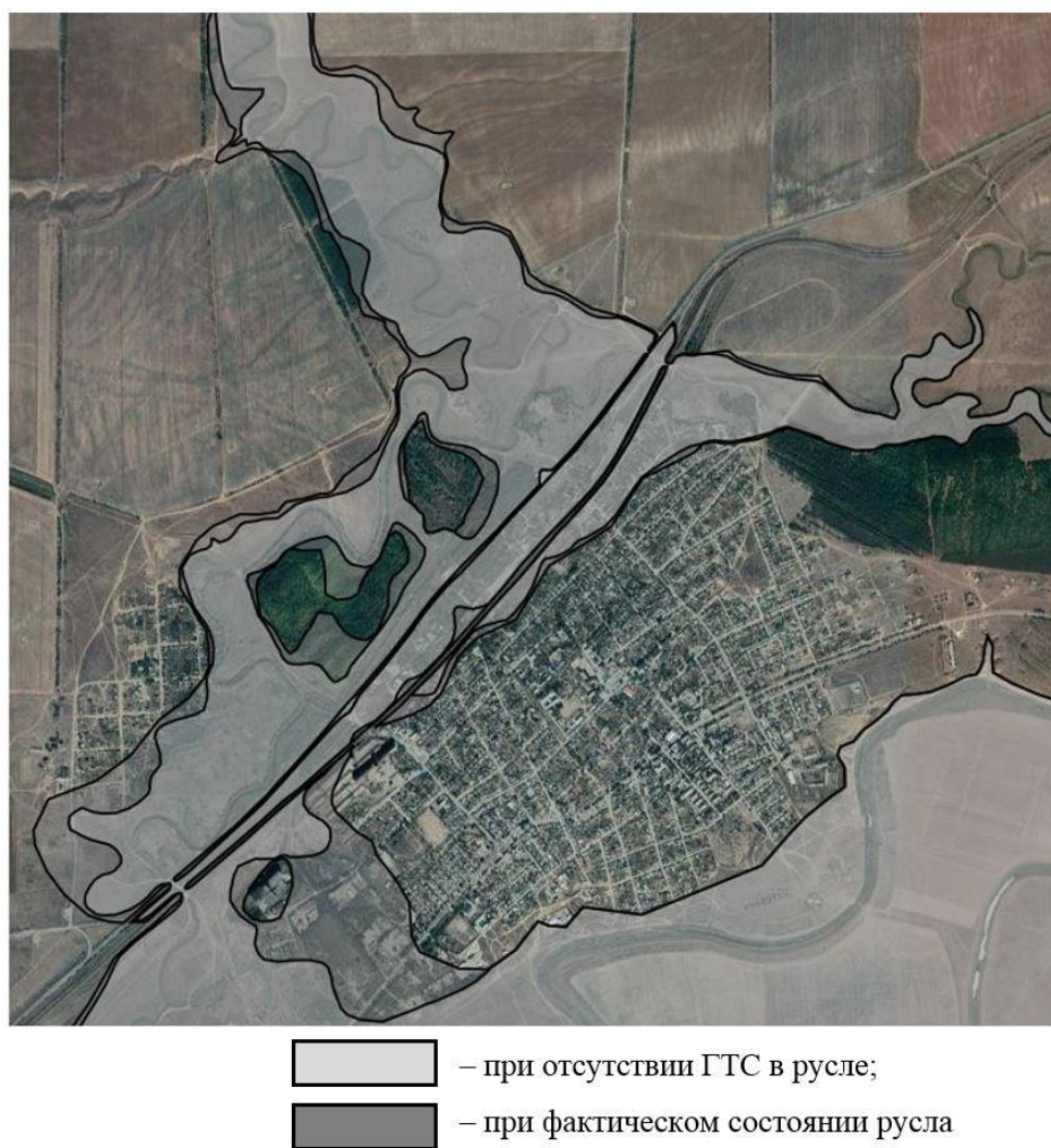
Рисунок 3 – Схема распространения зоны затопления при паводке 1% обеспеченности
