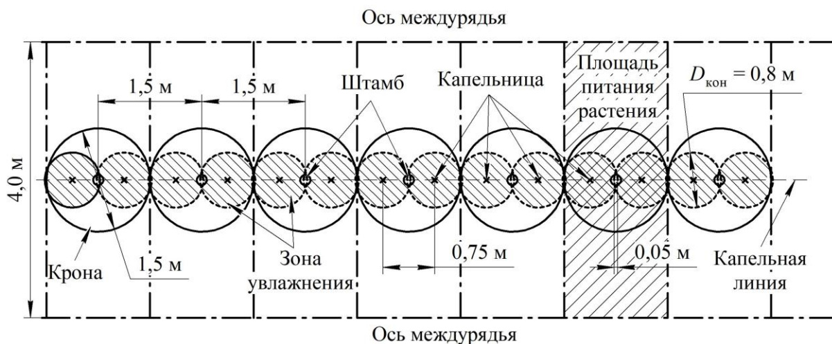
Рисунок 4 – Схема одностороннего поливного модуля с использованием двух капельниц на каждое дерево в условиях тяжелосуглинистых почв
